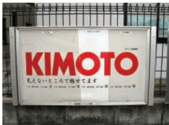
ラククリーンFT試験施工（中央が貼付部分）
