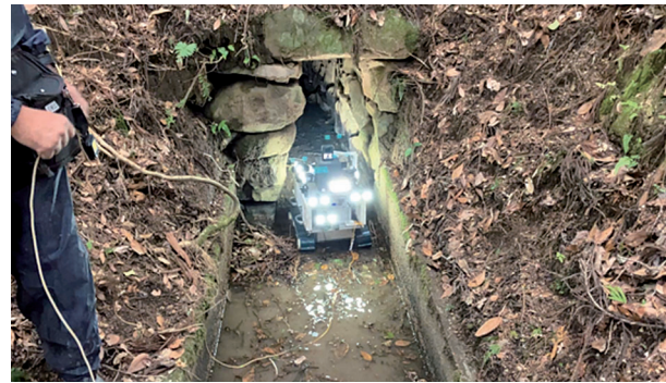
暗渠にロボットを投入(エイト日本技術開発提供)
