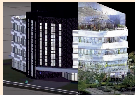
点群データから三次元モデルを作成
